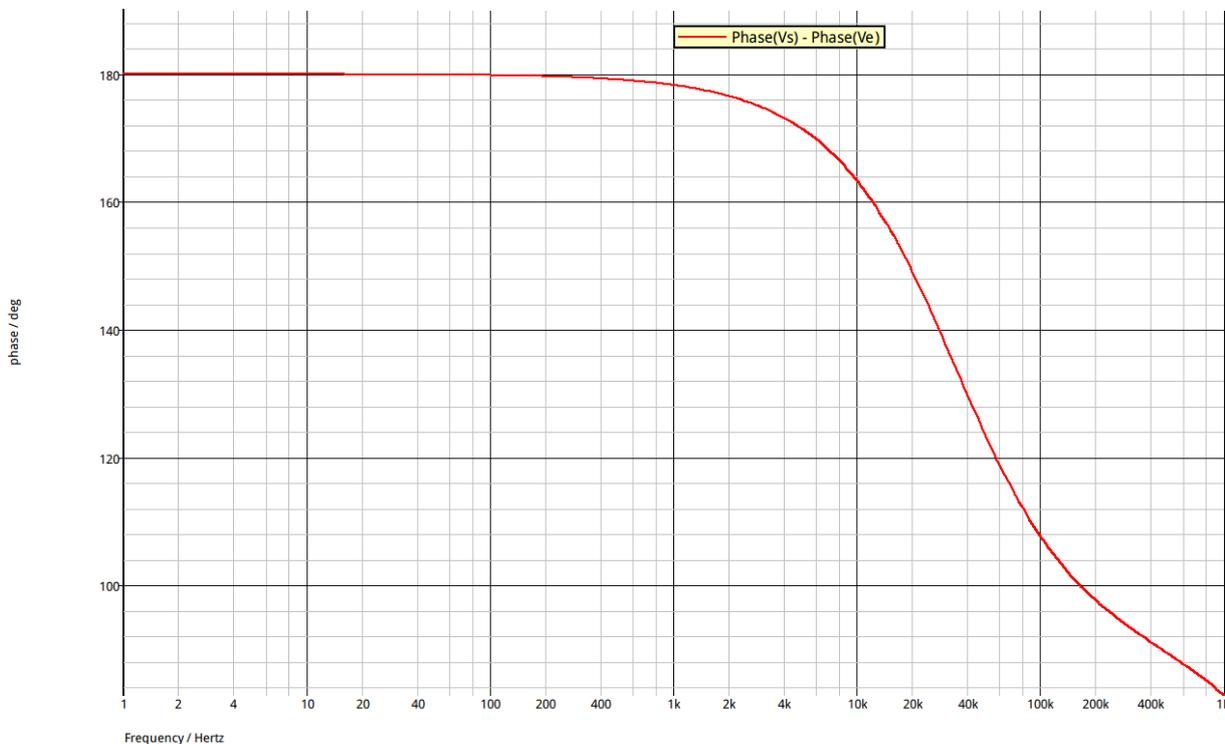
Aux basses fréquences, l'ampli. op. se comporte bien en amplificateur inverseur puisque  $\varphi = 180^\circ$  mais l'influence de la fonction de transfert se fait sentir dès 400Hz environ. On obtient comme prévue par le modèle une phase de  $145^\circ$  à la fréquence de coupure. Le modèle simple choisi pour l'expression de ( $\mu$ ) ne rend pas compte correctement de la phase à très haute fréquence.
