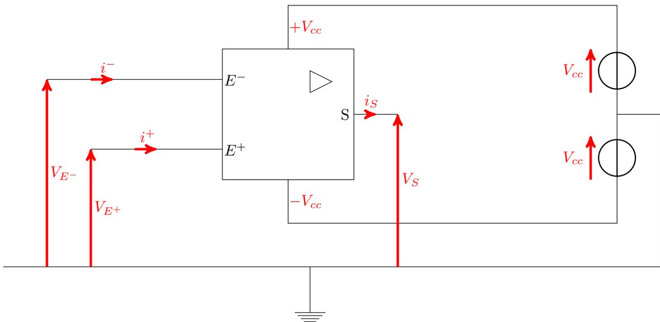
Nous nous intéressons maintenant aux variations de la tension de sortie  $V_S$  en fonction de la tension différentielle :  $\varepsilon = V_{E+} - V_{E-}$ . Aux fréquences pas trop élevées (pas plus de quelques kilohertz pour les modèles d'ampli. op. les plus courants) la fonction de transfert  $f$  telle que  $V_S = f(V_e)$  se représente graphiquement de la façon suivante :
